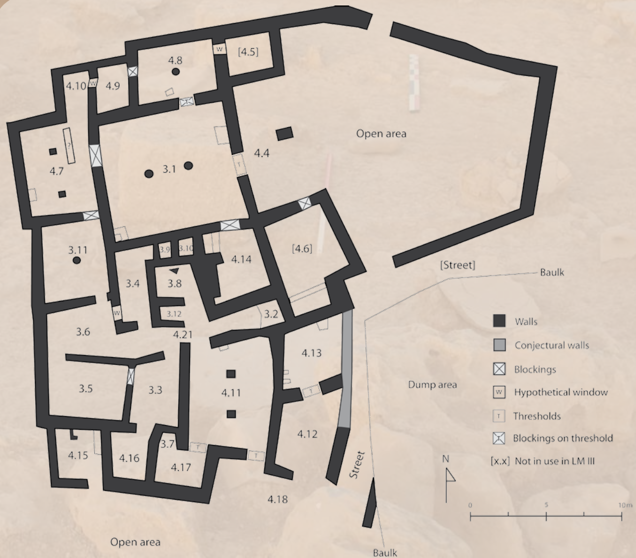
Σχεδιαστική αποτύπωση της κάτοψης του κτηρίου CD, όπου φαίνονται οι φραγμένες εισόδους
